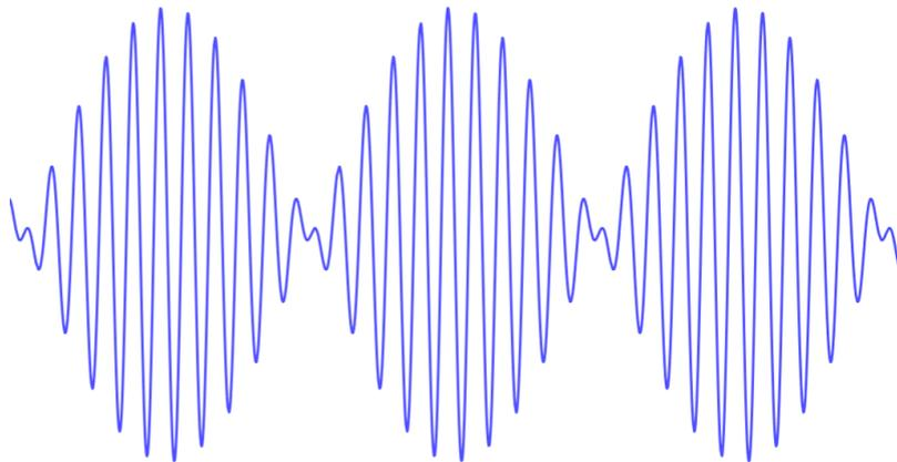
**Abbildung 2.3:** Schwebung: Man sieht die Überlagerung zweier Schwingungen mit unterschiedlichen Frequenzen.  $f_1 = 1.1Hz$ ,  $f_2 = 1.0Hz$
