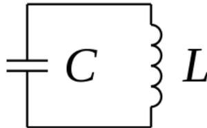
**Abbildung 2.9:** Einfacher idealer Schwingkreis mit Spule und Kondensator.
