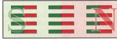
**Abbildung 2.4:** Schematische Darstellung eines Ferromagneten. Dabei stellen die Pfeile/Stabmagneten die Elektrospins dar.
