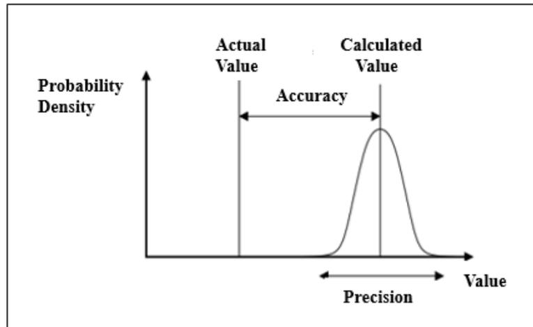
**Abbildung 2.10:** Schematische Darstellung von Messfehler. Wichtig anzumerken ist, dass die Genauigkeit (“accuracy”) das grössere Problem ist, da mehrere Messungen das Problem nicht beheben.
