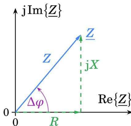
**Abbildung 2.7:** Zeigerdiagramm der Impedanz. Die Phasendifferenz  $\Delta\varphi$  gibt die Phasendifferenz zwischen Spannung und Stromstärke.
