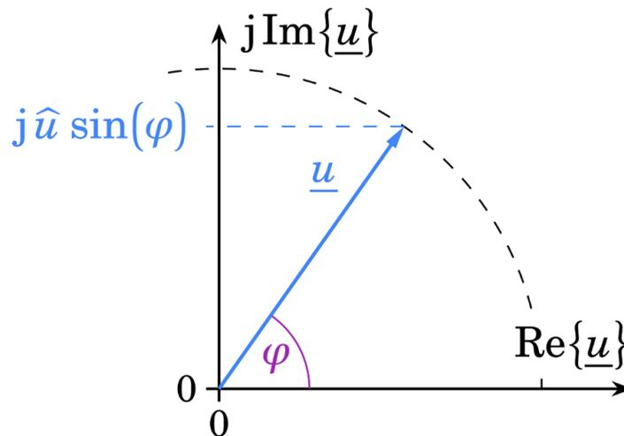
**Abbildung 2.6:** Zeigerdiagramm des Wechselstroms. Dabei befindet sich das Diagramm in der Komplexen Ebene.
