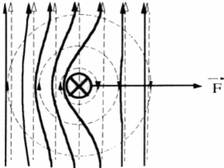
**Abbildung 2.5:** Die durchgezogenen Linien zeigen das resultierende Magnetfeld, wobei durch das Kreuz gekennzeichnet wird, dass der Leiter “in die Ebene” geht. Die gestrichelten Linien sind die einzelnen Magnetfelder.
