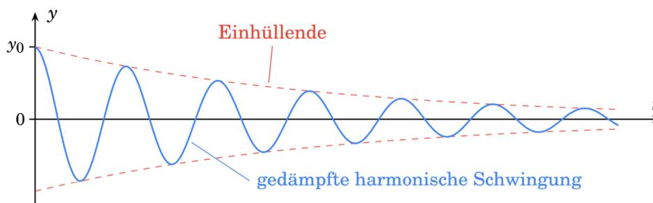
**Abbildung 2.2:** Gedämpfte harmonische Schwingung: Die Einhüllende ist gegeben durch die Amplituden zum Zeitpunkt  $t$  mit  $\hat{x}(t) = x_0 e^{-\delta t}$ . Trivialerweise wird diese Kurve an  $x = 0$  beziehungsweise hier  $y = 0$  gespiegelt.
