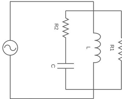
**Abbildung 2.8:** Wechselstromkreis: Es sind Widerstand  $R_2$  und Kapazität  $C$  seriell geschaltet. Parallel dazu sind eine Spule  $L$  und ein Widerstand  $R_1$ .
