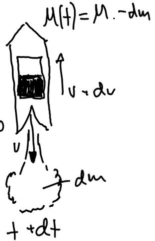
$$p(t+dt) = (M-dm) \cdot (v+dv) + dm(v-u) \rightarrow \text{durdv ist vernachlässigbar}$$
