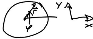
$$\vec{v}(t) = \dot{\vec{r}}(t) = \omega r \begin{pmatrix} -\sin(\omega t + \varphi_0) \\ \cos(\omega t + \varphi_0) \end{pmatrix} \Rightarrow v = \omega r$$
